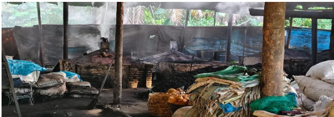
Gambar 4. Tungku pembakara tempurung kelapa dengan katup (system asap)
