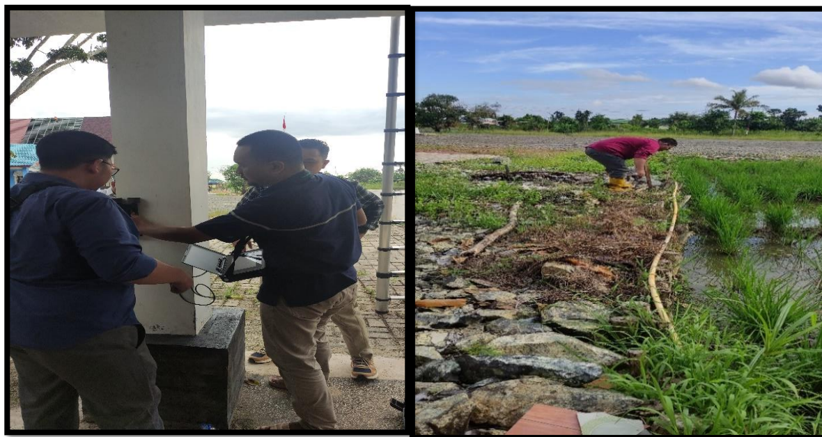
Gambar 3. Pemeriksaan volume tulangan menggunakan profometer dan perhitungan kuantitas pancangan galam
