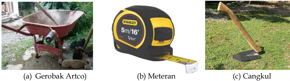
Gambar 6. Alat pembongkaran dan persiapan pembangunan
